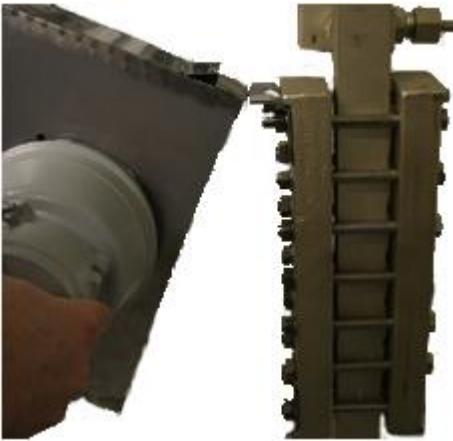
Nun kann der Lichtleitkasten mit der gebogenen Seite in den entsprechenden Befestigungswinkel eingehängt werden.
