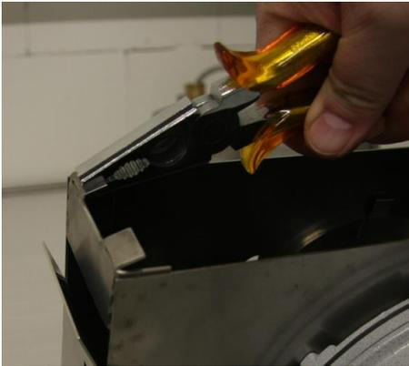
Die Beleuchtungseinheit kann aus der Sichttrichtung mit dem Glühlampengehäuse sowohl rechts als auch links angebracht werden. Dabei müssen die beiden Zungen der Halterung an der oberen Lichtkastenseite mithilfe einer Zange um ca. 60° umgebogen werden.
