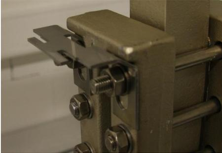
Die Befestigung der Beleuchtungseinheit mit Halogenglühlampe erfolgt mit dem angebrachten Befestigungswinkel am Glasanzeiger.
