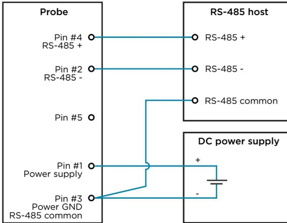
Figure 5 RS-485 wiring
