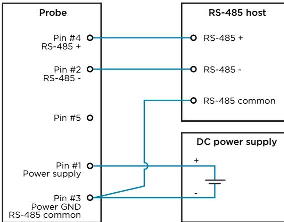
Figure 5 RS-485 wiring
