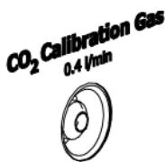
$\text{CO}_2$  測定に対応している変換器モデルには、校正用ガスのインレットが備わっています。シリコンチューブ（内径 3 mm）を使用し、流量 0.4 L/分で、このインレットに既知濃度（例: 1000 ppm）で校正用ガスを供給します。
