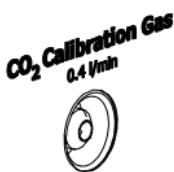
Messwertgebermodelle mit CO<sub>2</sub>-Messung besitzen einen Einlass für Kalibriergas. Führen Sie diesem Einlass Kalibriergas mit bekannter Konzentration (z. B. 1000 ppm) über einen Silikonschlauch mit einem Innendurchmesser von 3 mm und einer Durchflussrate von 0,4 l/min zu.
