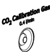
Os modelos de transmissor com medição de CO<sub>2</sub> possuem uma entrada para gás de calibração. Forneça o gás de calibração com uma concentração conhecida (por exemplo, 1000 ppm) nessa entrada usando um tubo de silicone com diâmetro interno de 3 mm e um fluxo de 0,4 l/min.
