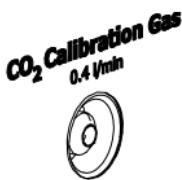
具有 CO<sub>2</sub> 测量功能的变送器型号具有一个校准气进气口。使用 3 毫米内径的硅树脂管向此进气口中以 0.4 升/分钟的流速供应具有已知浓度（例如 1000 ppm）的校准气。
