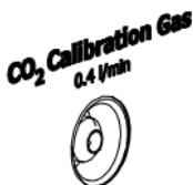
Les modèles de transmetteurs avec mesure du CO<sub>2</sub> disposent d'une entrée pour le gaz d'étalonnage. Appliquez le gaz d'étalonnage dont la concentration est connue (par exemple, 1 000 ppm) à cette entrée en utilisant un tuyau en silicium de 3 mm de diamètre interne et un débit de 0,4 l/min.
