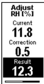
調整画面で、トリマーを回して目的の補正值を設定します。変更を確定するには、トリマーを回すのをやめてしばらく待ちます。
